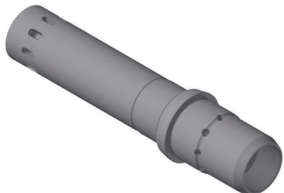
依照增材制造特点重新设计的滑动外壳部件
