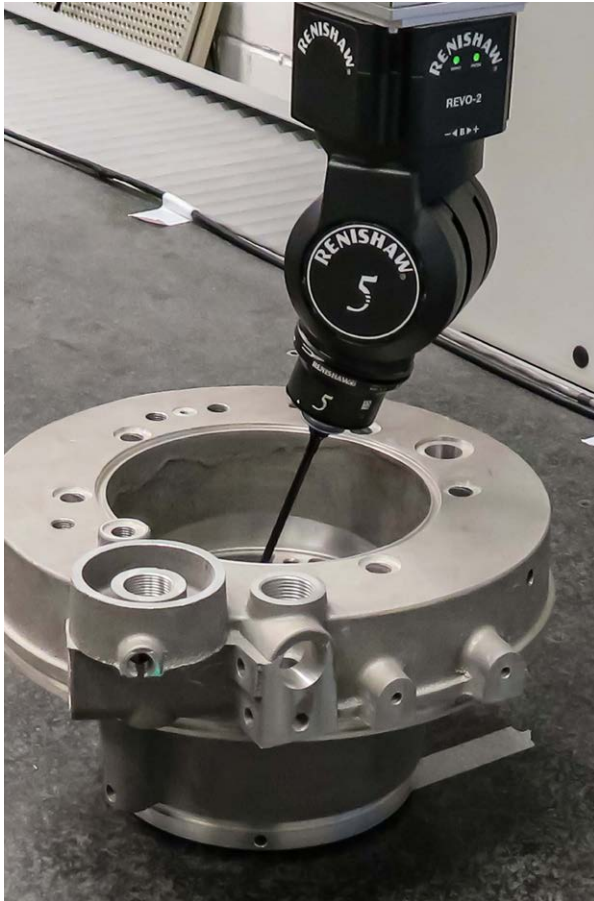
Cabeçote REVO de 5 eixos fornece capacidade de posicionamento infinita
