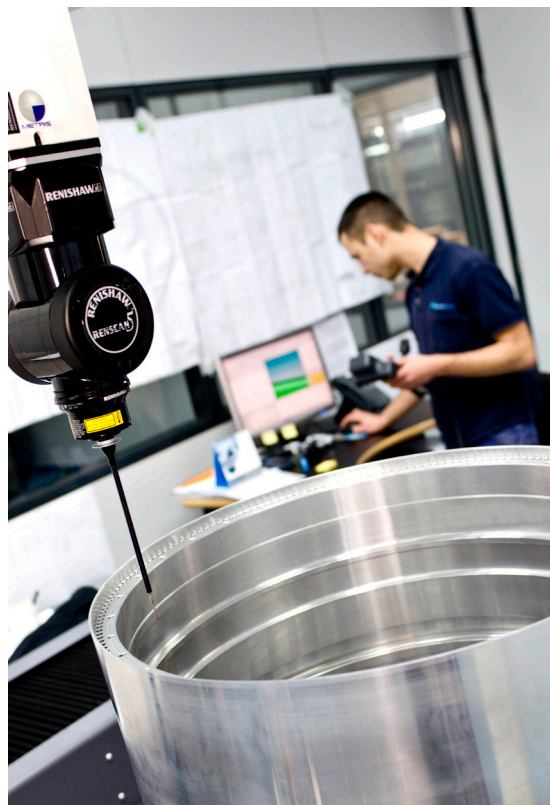
A REVO rendszer egy repülőgép-alkatrész nagyméretű furatának szkenneléses vizsgálata közben.
